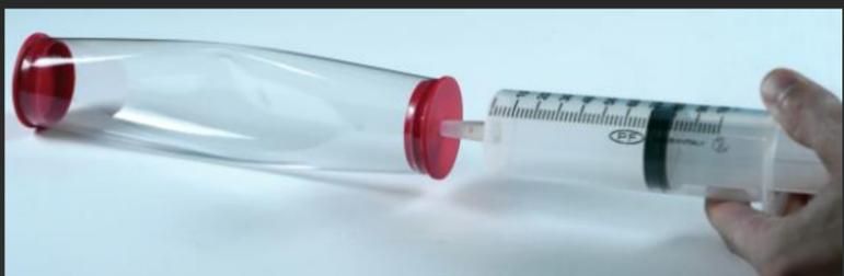
Raggiunto un certo limite di carico (**pressione critica**) la struttura si instabilizza.
