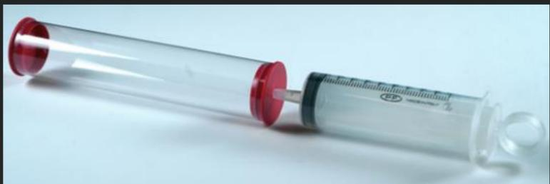
Le **strutture cilindriche** quando soggette a carichi di **pressione** resistono grazie alla nascita di azioni interne di compressione.
